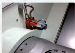
Обнаружение сломанного инструмента: фрезы или сверла
