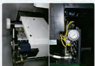
Система контроля регулировки давления в гидравлической системе
