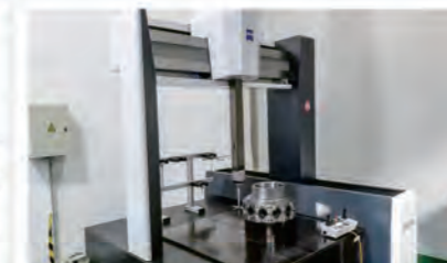
Координатно-измерительная машина ZEISS
