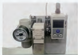
Контроль герметичности пневматической системы
