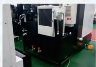
Система постоянного поддержания температуры СОЖ
